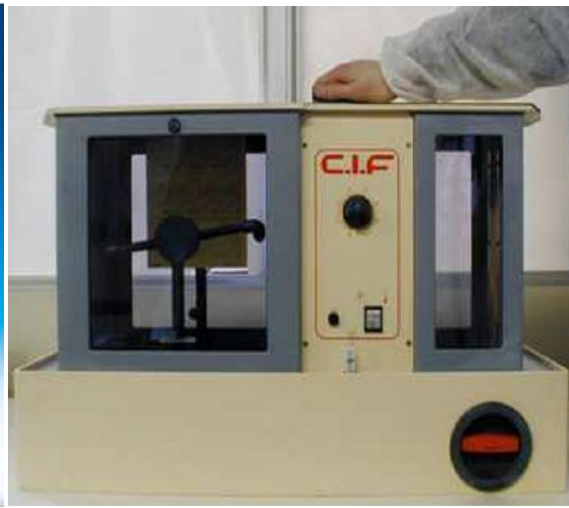
Figure IV.3 Machine à graver par pulvérisation avec rinçage
